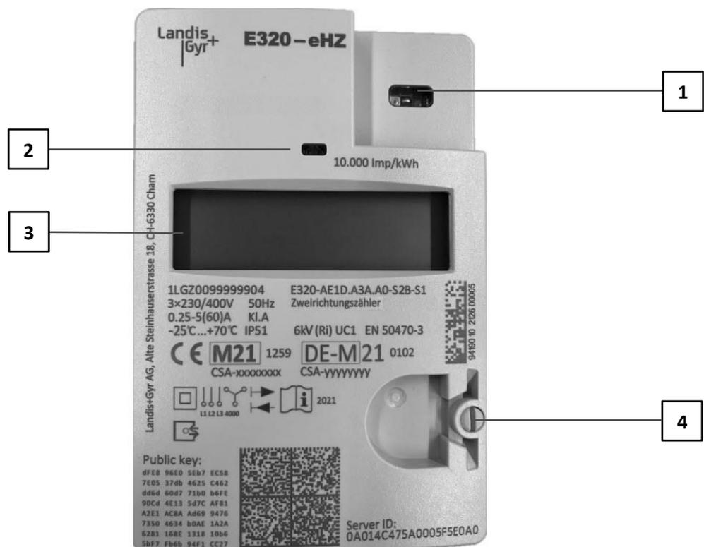
Figure 3. Zählergehäuse
