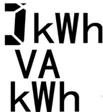
Die Kombination dieser Symbole wird verwendet, um eine Einheit zu erstellen, die für die aktuell angezeigte Messgröße geeignet ist, z.B. "kWh", "W", "A" oder "V". Wenn die Frequenz angezeigt wird, fehlt die Einheit.
