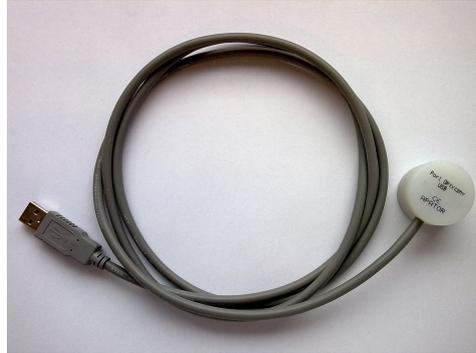
Die in Apator S.A. verfügbare SML-Service-Software kann verwendet werden, um den Zähler über den INFO-Anschluss auszulesen.
