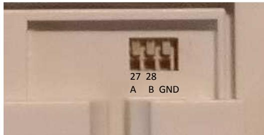
Der Adapter bildet eine Erweiterung der Zähler-Schnittstelle und ermöglicht die Kommunikation mit SMGW. Am Adapter gibt es zwei LMN-Ports (1 und 2). Beschreibung vom Anschluss des LMN-Portes,
